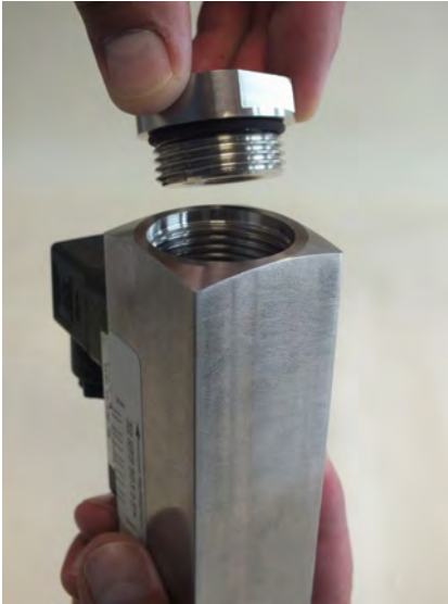
Abb. 37: Verschraubung (Ausgang) abnehmen
