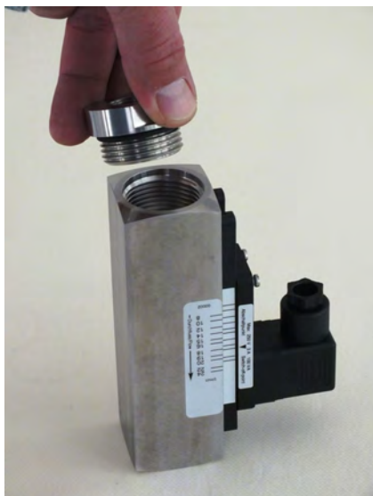
Abb. 42: Verschraubung (Eingang) abnehmen
