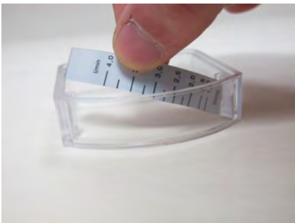
Abb. 41: Skalenträger aus Führung ziehen
