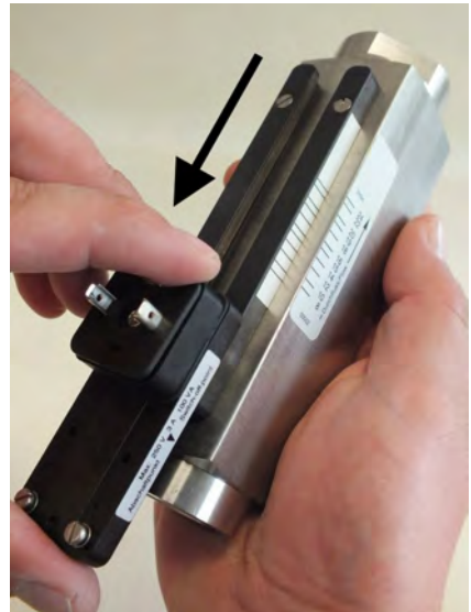
Abb. 68: Schaltkontakt aus Führung schieben
