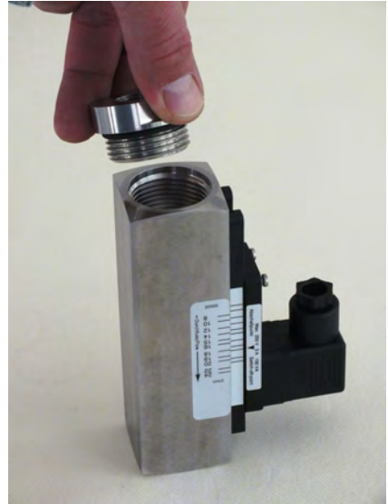
Abb. 49: Verschraubung (Eingang) abnehmen
