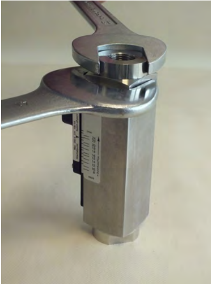
Abb. 43: Verschraubung (Ausgang) lösen
