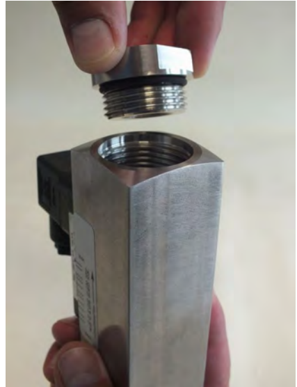
Abb. 44: Verschraubung (Ausgang) abnehmen
