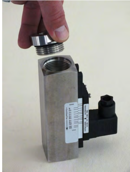
Abb. 52: Verschraubung (Eingang) einsetzen
