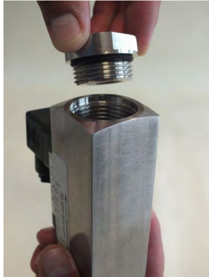
Abb. 57: Verschraubung (Ausgang) einsetzen
