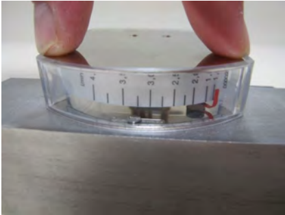
Abb. 63: Anzeige-Deckelplatte in Gehäuse einlegen
