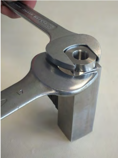
Abb. 48: Verschraubung (Eingang) lösen
