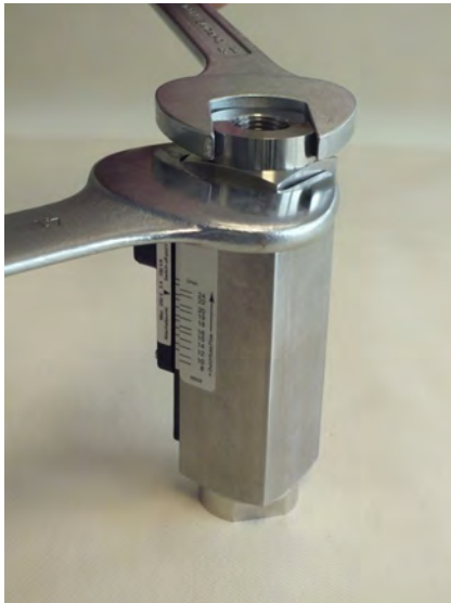
Abb. 58: Verschraubung (Ausgang) festziehen
