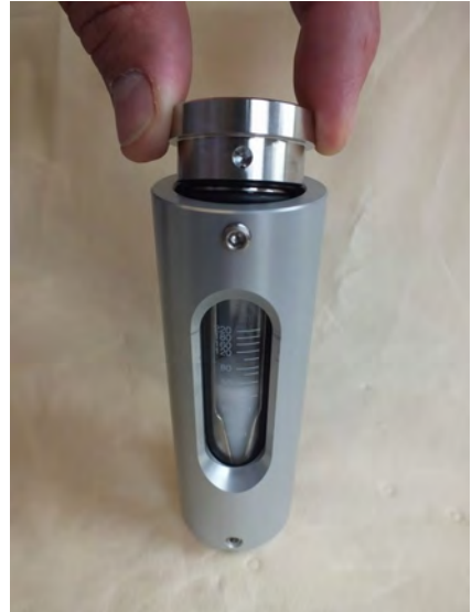
Abb. 36: Verschraubung (Ausgang) abnehmen
