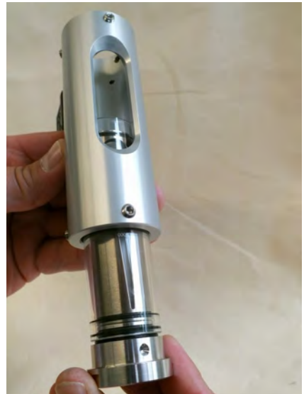
Abb. 50: Verschraubung in Gerätehülse schieben
