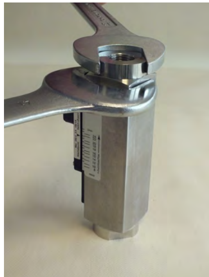
Abb. 35: Verschraubung (Ausgang) lösen
