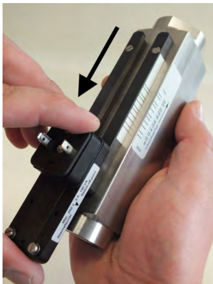
Abb. 55: Schaltkontakt aus Führung schieben
