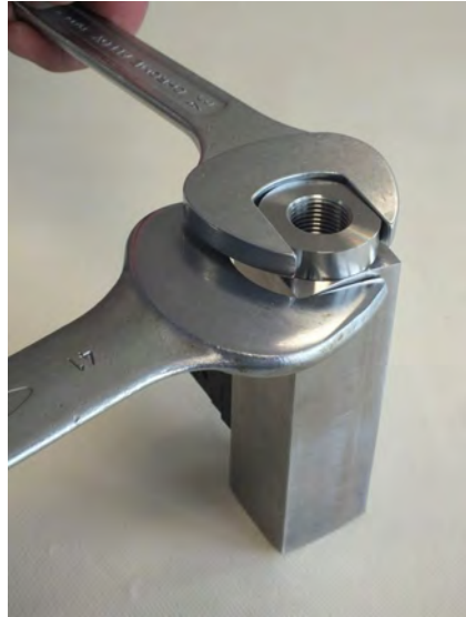
Abb. 40: Verschraubung (Eingang) lösen
