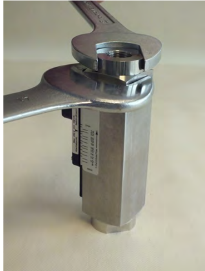
Abb. 50: Verschraubung (Ausgang) festziehen
