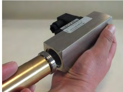
Abb. 49: Gewinding (Eingang) einführen
