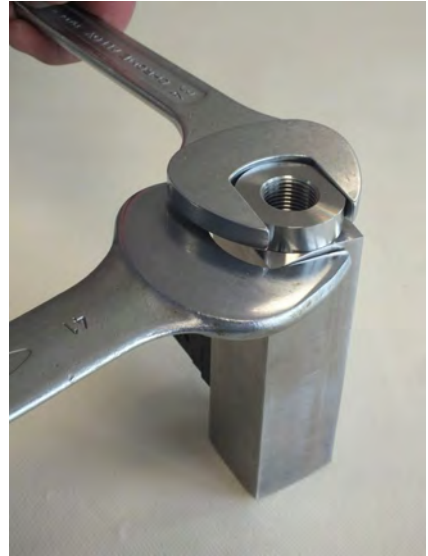
Abb. 52: Verschraubung (Eingang) festziehen
