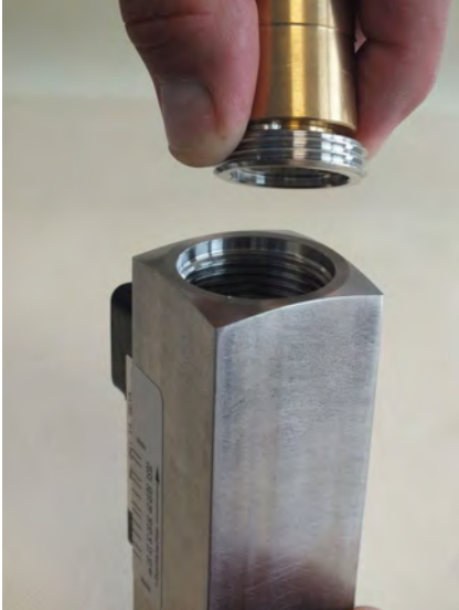
Abb. 39: Gewinding (Ausgang) entnehmen
