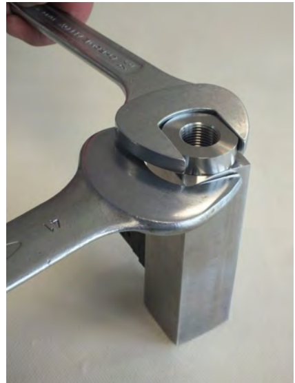
Abb. 42: Verschraubung (Eingang) lösen
