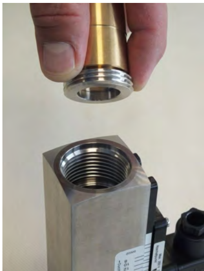
Abb. 46: Gewinding (Eingang) entnehmen
