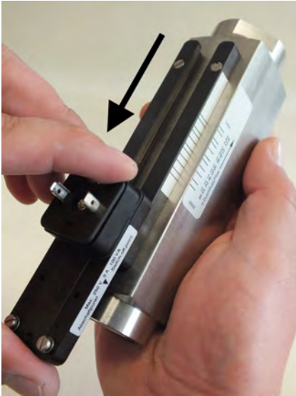
Abb. 63: Schaltkontakt aus Führung schieben
