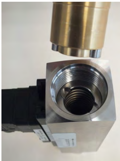
Abb. 44: Eindrehwerkzeug Gewinding (Eingang) einführen
