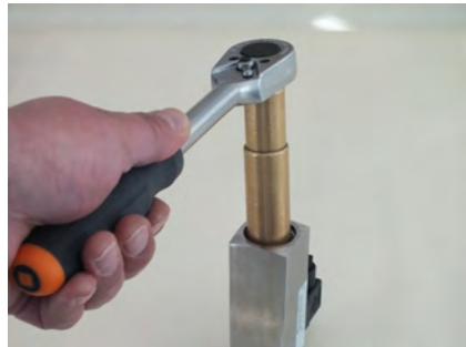
Abb. 50: Gewinding (Eingang) festziehen
