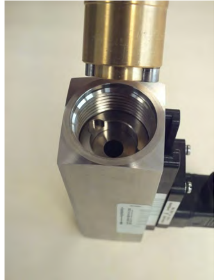
Abb. 37: Eindrehwerkzeug-Gewinding einführen (Ausgang)
