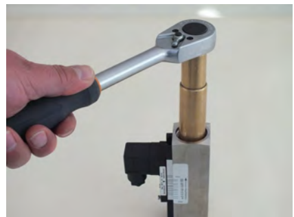
Abb. 38: Gewinding (Ausgang) lösen
