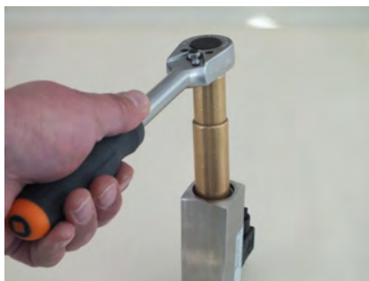
Abb. 45: Gewinding (Eingang) lösen
