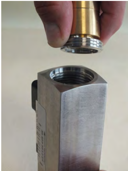
Abb. 55: Gewinding (Ausgang) einführen
