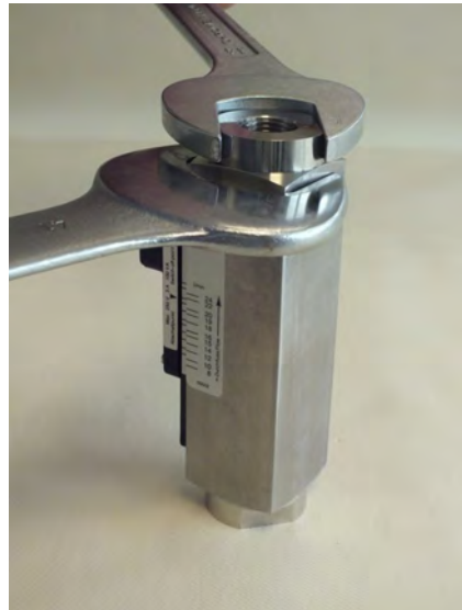
Abb. 35: Verschraubung (Ausgang) lösen
