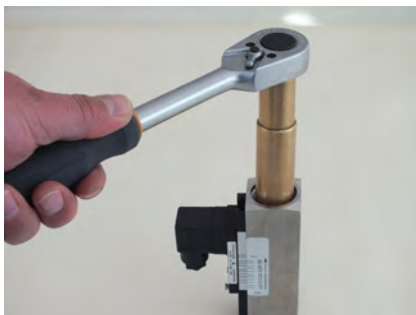
Abb. 56: Gewinding (Ausgang) festziehen
