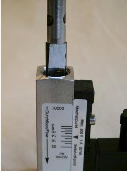
Abb. 40: Gewinding (Eingang) lösen
