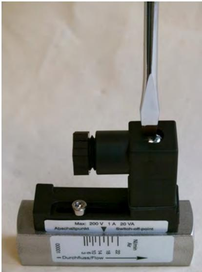
Abb. 49: Steckerdose lösen
