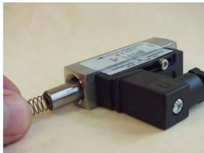
Abb. 37: Innenteile entnehmen
