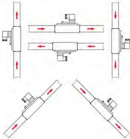
Abb. 5: Einbauposition/Durchflussrichtung
