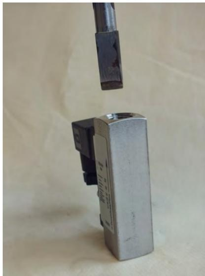
*Abb. 34: Eindrehwerkzeug-Gewindering einführen (Ausgang)*
