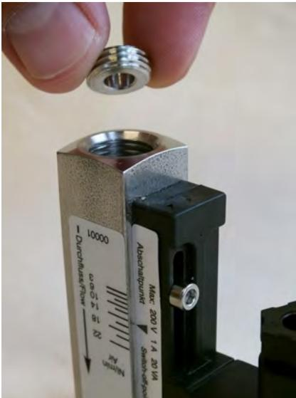
Abb. 42: Gewindering (Eingang) einführen
