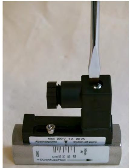
Abb. 20: Steckerdose lösen
