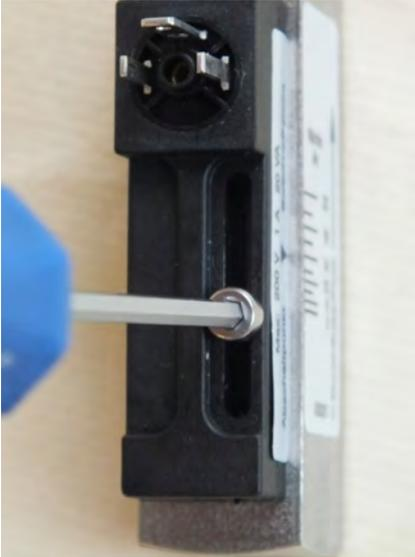
Abb. 51: Feststellschraube Schaltkontakt lösen
