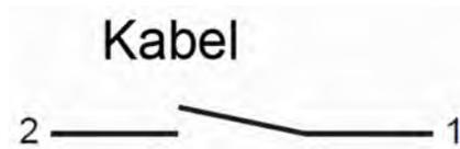
Abb. 19: Zustand des Kontaktes bei Gerät ohne Durchfluss
