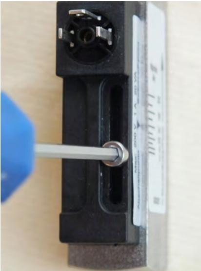
Abb. 32: Feststellschraube lösen
