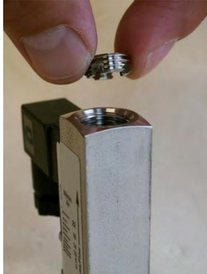
Abb. 36: Gewinding (Ausgang) entnehmen
