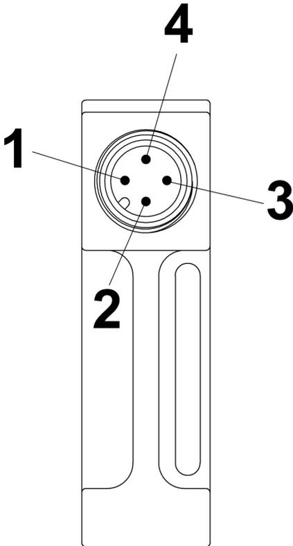
Abb. 16: Pin-Belegung Gerätestecker M12x1 (Form 15x50)
