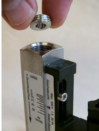
Abb. 41: Gewinding (Eingang) entnehmen
