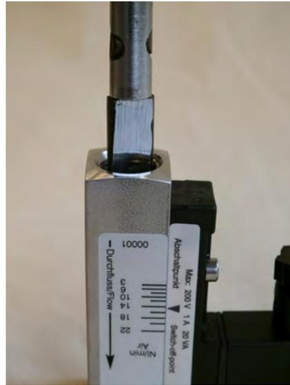
Abb. 43: Gewindering (Eingang) festziehen
