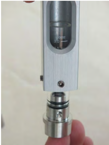
Abb. 45: Verschraubung in Geräte- hülse schieben
