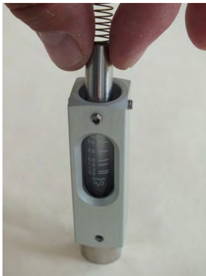
Abb. 48: Schwebekörper und Feder einführen
