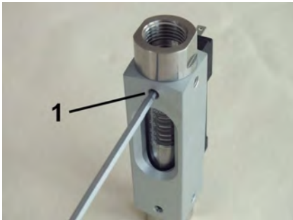
Abb. 35: Verschraubung (Ausgang) abnehmen
