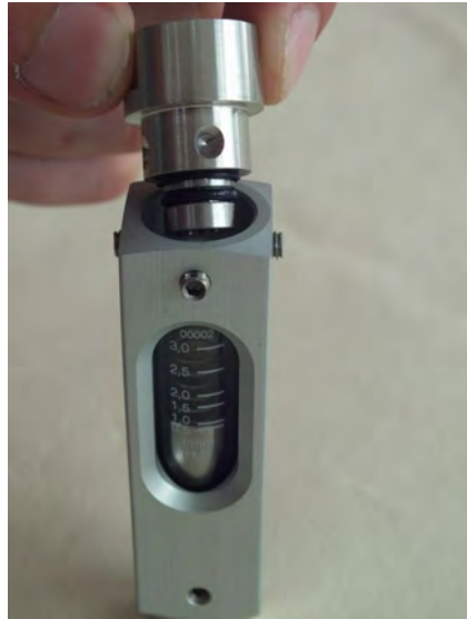
Abb. 35: Verschraubung (Ausgang) abnehmen
