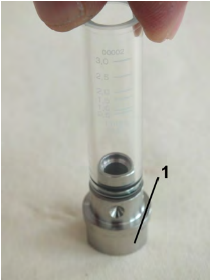
Abb. 43: Verschraubung (Eingang) in Schauglas
