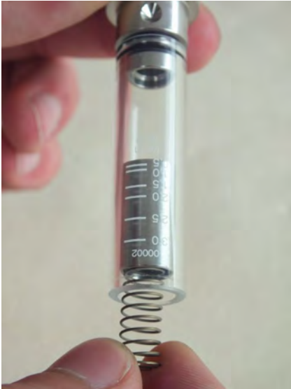
Abb. 38: Schwebekörper und Feder entnehmen
