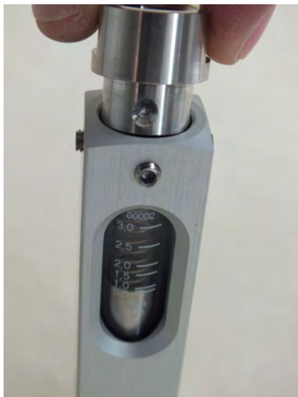
Abb. 49: Verschraubung (Ausgang) in Gerätehülse einsetzen
