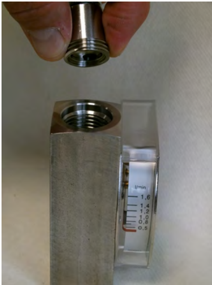
Abb. 57: Gewinding (Ausgang) einführen
