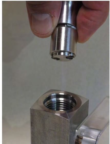
Abb. 44: Eindrehwerkzeug-Gewindering einführen (Ausgang)
