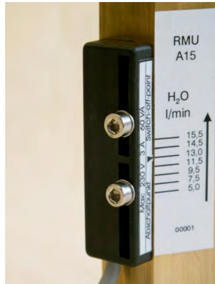
Abb. 25: Schaltwert ablesen (Beispiel-skala)
