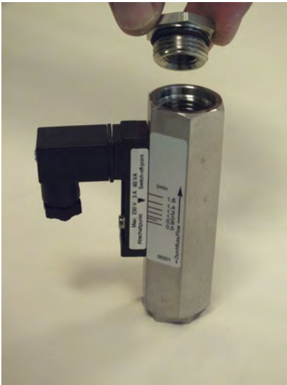
Abb. 52: Verschraubung (Ausgang) einsetzen
