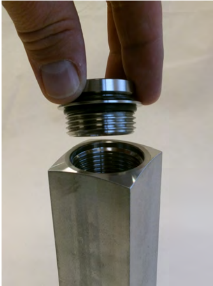
Abb. 45: Adapter (Ausgang) abnehmen
