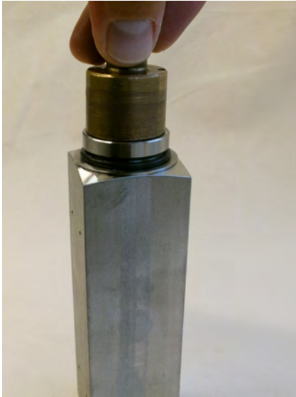
Abb. 41: Adapter (Ausgang) lösen
