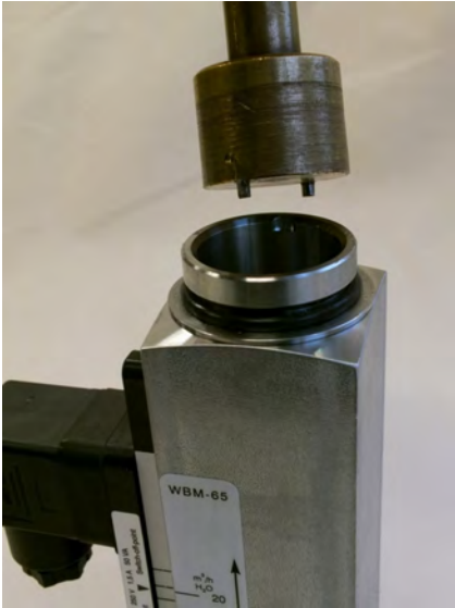
Abb. 43: Eindreihwerkzeug-Adapter einführen (Ausgang)
