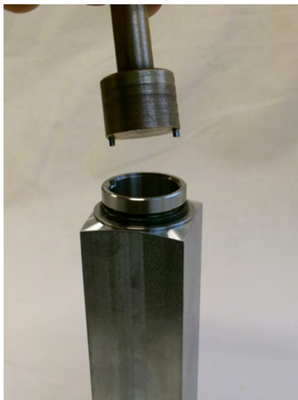
Abb. 40: Eindrehwerkzeug-Adapter einführen (Ausgang)
