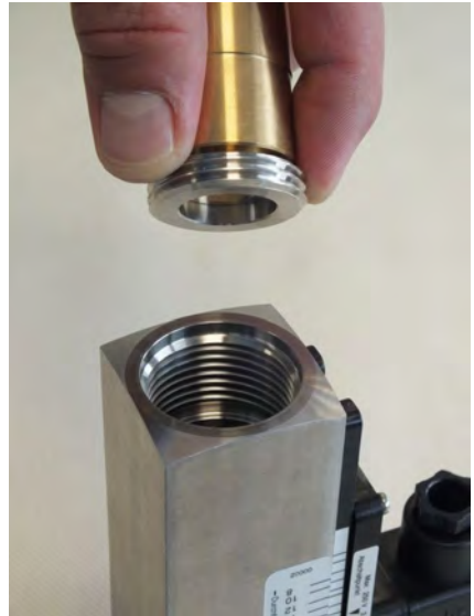
Abb. 53: Gewindering (Eingang) entnehmen
