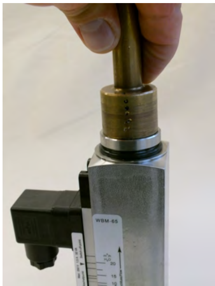
Abb. 65: Adapter (Ausgang) festziehen
