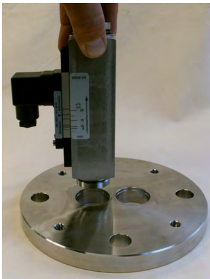
Abb. 39: Gerätekörper (Strömungswächter) abnehmen
