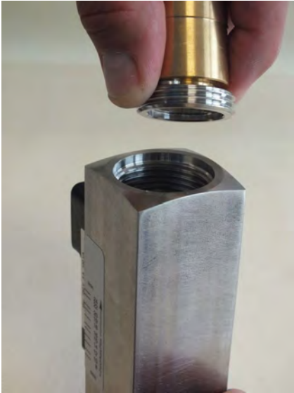
Abb. 58: Gewinding (Ausgang) einführen
