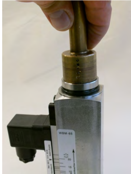
Abb. 44: Adapter (Ausgang) lösen
