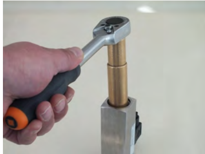
Abb. 55: Gewinding (Eingang) festziehen
