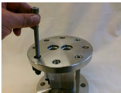
Abb. 70: Schrauben Geräteverbindung einführen (Ausgang)
