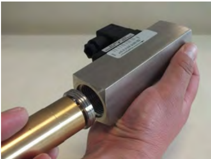
Abb. 54: Gewinding (Eingang) einführen
