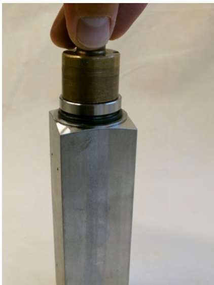
Abb. 63: Adapter (Ausgang) festziehen
