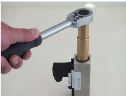
Abb. 59: Gewinding (Ausgang) festziehen
