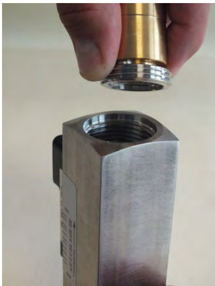
Abb. 48: Gewinding (Ausgang) entnehmen
