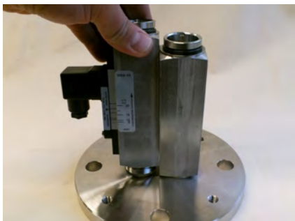
Abb. 68: Gerätekörper (Strömungswächter) aufstecken
