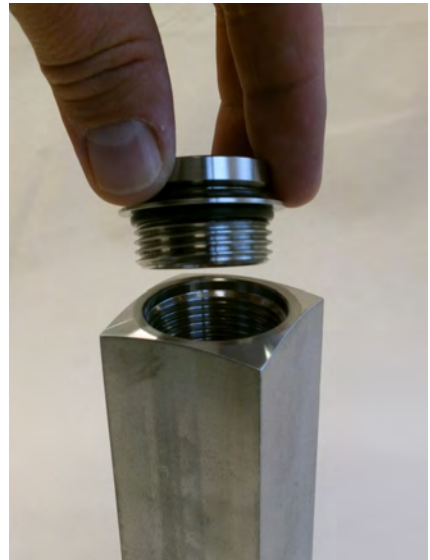
Abb. 62: Adapter (Ausgang) einführen
