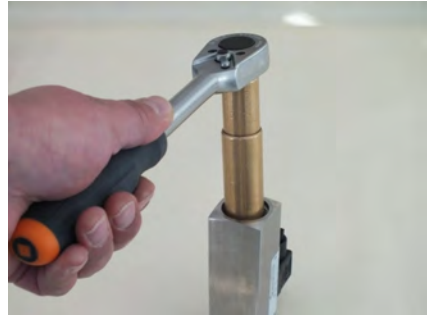
Abb. 52: Gewindering (Eingang) lösen
