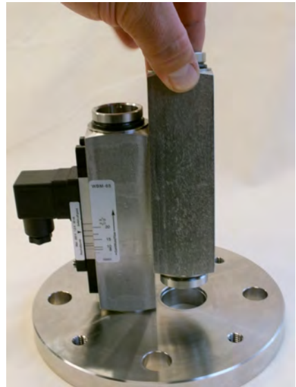
Abb. 38: Gerätekörper (Bypass) abnehmen
