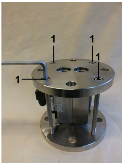
Abb. 35: Schrauben Geräteverbindung lösen (Ausgang)
