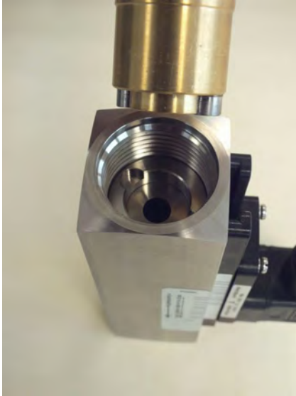
Abb. 51: Eindrehwerkzeug Gewindering (Eingang) einführen
