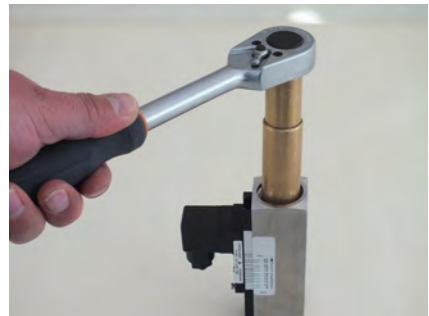
Abb. 47: Gewindering (Ausgang) lösen
