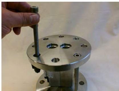
Abb. 36: Schrauben Geräteverbindung entnehmen (Ausgang)
