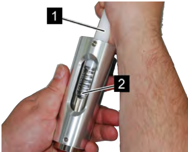
Fig. 54: Align slot nozzle
