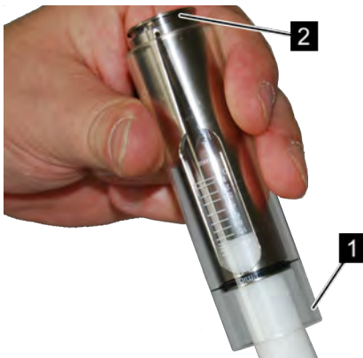
Fig. 46: Insert slot nozzle
