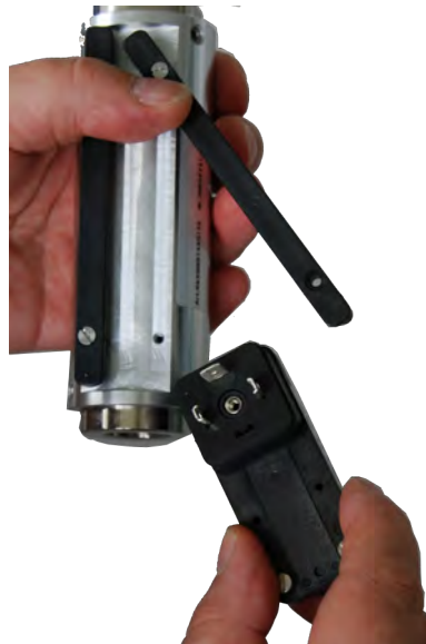
Fig. 64: Remove switch contact
