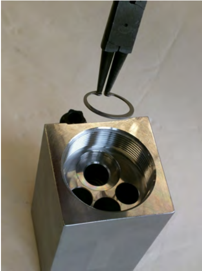
Fig. 42: Insert snap ring (inlet)
