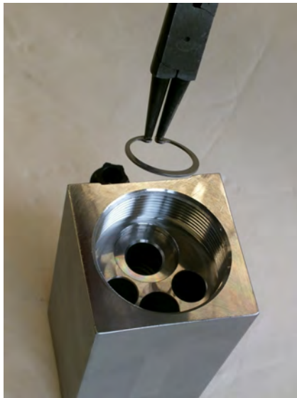
Fig. 37: Remove snap ring
