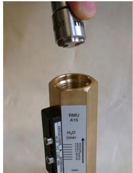
Abb. 22: Eindrehwerkzeug-Gewindering einführen (Ausgang)
