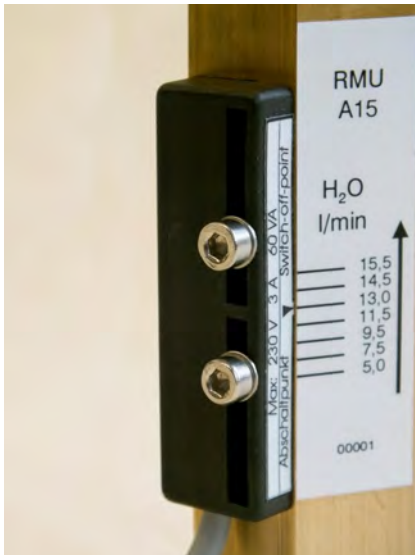
Abb. 21: Schaltwert ablesen (Beispiel-skala)
