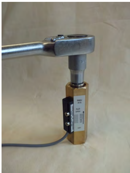
Abb. 23: Gewinding (Ausgang) lösen
