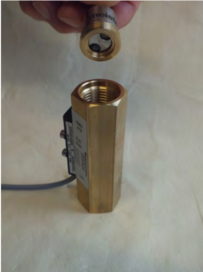
Abb. 29: Gewinding (Ausgang) einführen
