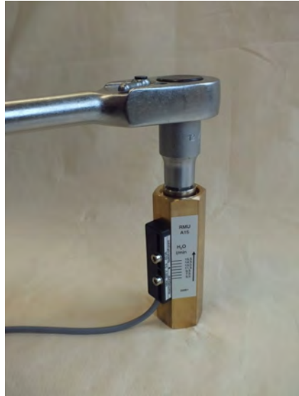
Abb. 30: Gewinding (Ausgang) festziehen
