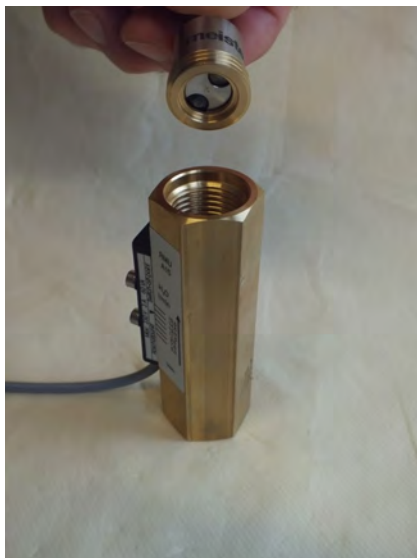
Abb. 24: Gewinding (Ausgang) entnehmen
