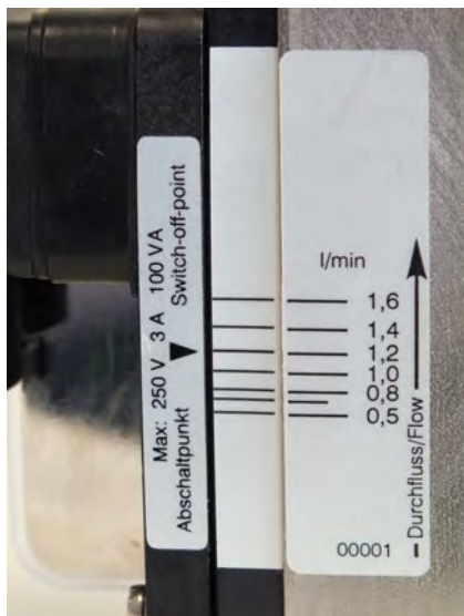
Abb. 36: Schaltwert ablesen (Beispiel-skala)
