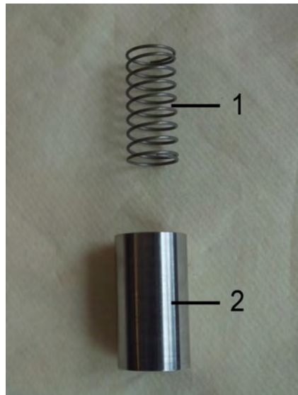
Abb. 49: Feder und Schwebekörper
