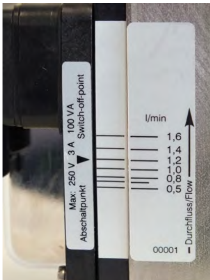
Abb. 36: Schaltwert ablesen (Beispiel-skala)
